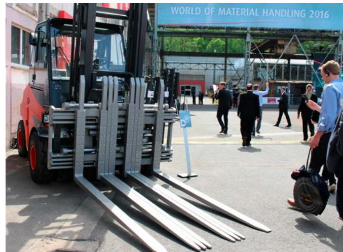
Prezentován byl elektrický vozík E80/900 určený k manipulaci s osmi paletami, který využívají nápojáři. Podobná konfigurace se pro výrobce nápojů používá i s dieselovým pohonem. Jeden velký vozík s nosností kolem osmi tun dokáže podstatně zrychlit nakládku kamionů, a to z desítek na jednotky minut.
